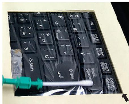
図1 キーボード上のATP/ADP/AMP量の測定方法
