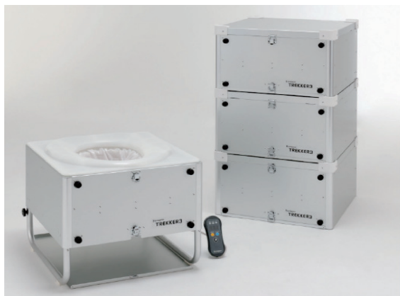
写真5 簡易トイレの一例「ラップボン」 箱の中心に専用ラップをセットし、使用後のボタンをコンローラーのボタンを押せば自動的にラップが排泄物を包み密閉し切り落とす仕掛け。電源さえあればどこでも使用可。
