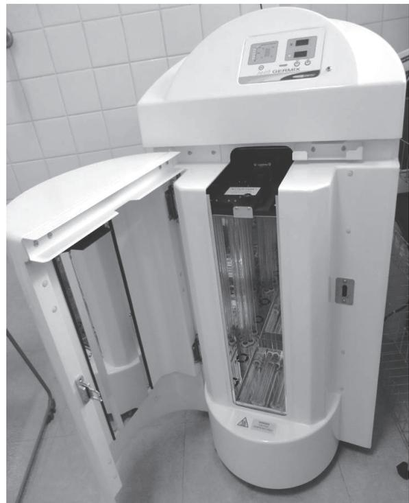
図1 検討に用いた紫外線照射器械 (Antigermix S1<sup>®</sup> Germitec)
