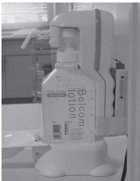
図1. 監視用データロガー組込み電動ディスペンサー(スマートポンプ AP-3)
