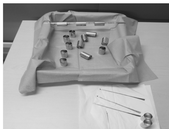
写真3. ステンレスカップ（外径25.3mm、内径23.0mm、長さ40.0mm）
