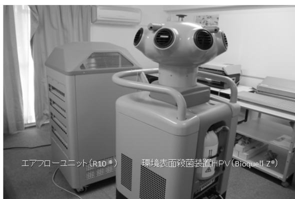
写真2. 蒸気化過酸化水素環境消毒法（Bioquell Z ® ゲティンゲ・ジャパン）
