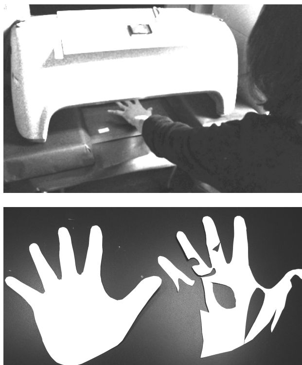
図 1 蛍光量測定機器（GlitterBug MAXI. CAM, (Brevis Co.)) による撮影（上）と塗布の有無によって切り抜かれた紙の一例（下）、手全体の切り抜き（左）とそこから塗布無部分を切り抜いた塗布有部分（右）
