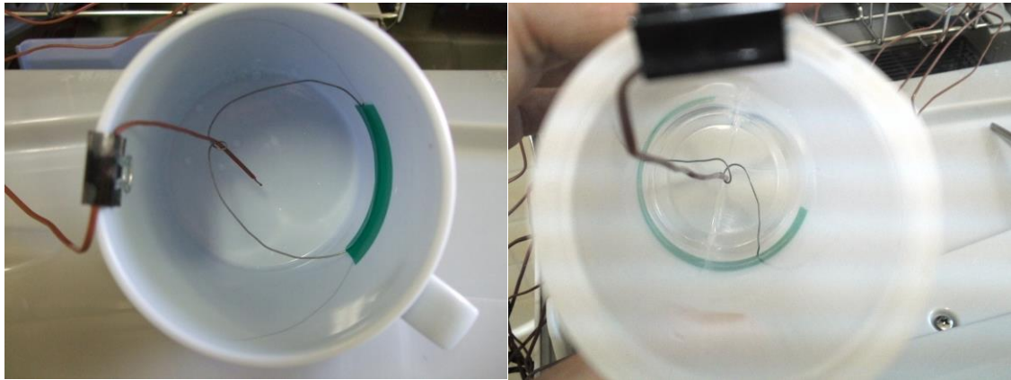
図3 サーモカップル先端が器材底面中央、底面から約1cm離れたところに位置するように固定した
