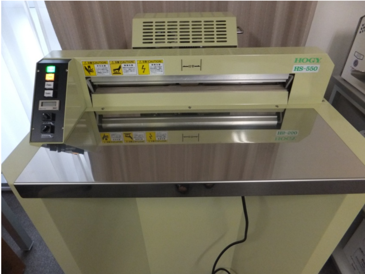
図7 ガセットタイプ用、新定温保持タイプシーラー（HOGY 株式会社 HS-550）
