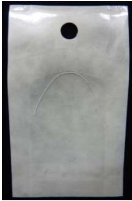
図 3 糸状生物学的インジケータ (Suture Biological Indicator: SBI)
