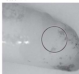
写真2 各種清涼飲料水に6週間の浸漬を終えた光重合型コンポジットレジン充填歯のエナメル質表面(×25)
