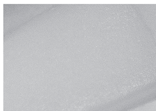
写真5 各清涼飲料水に6週間浸漬し、その間に電動歯ブラシと歯磨剤を用いて6回磨かれた歯のエナメル質表面(×25)
