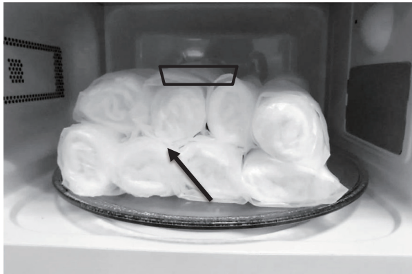
図 1 タオル設置例：小タオル 8 本（4 列 2 段） 矢印は温度測定用 K 型熱電対センサー挿入部 黒枠囲いは切片配置部
