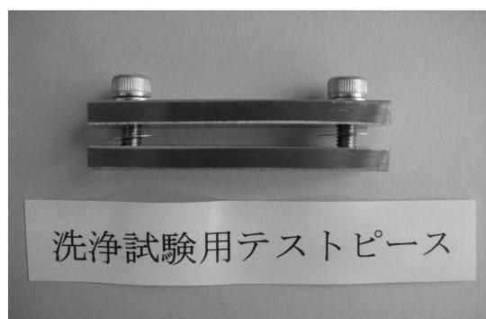
図1. 汚染モデル器材として使用したテストピース
