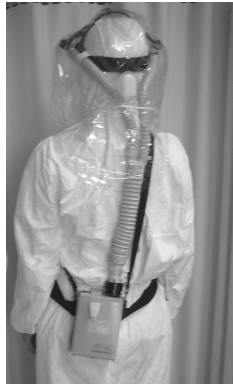
重松製作所製荏原病院仕様の PAPR フィットテスターの端子を装着した場面（丸部分が端子）
