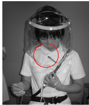
重松製作所製荏原病院仕様の PAPR フィットテスターの端子を装着した場面（丸部分が端子）
